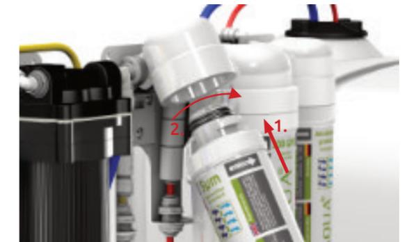
Setzen Sie die neuen Filtereinheiten in die Filterköpfe ein und drehen Sie dabei die Filterkartuschen um 90° im Uhrzeigersinn. Die Filtereinheiten müssen anschließend in den Befestigungsschellen einrasten.
